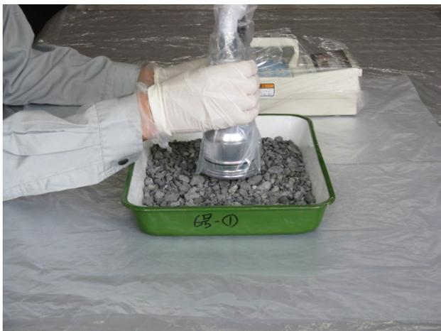
コンクリート用骨材の測定
