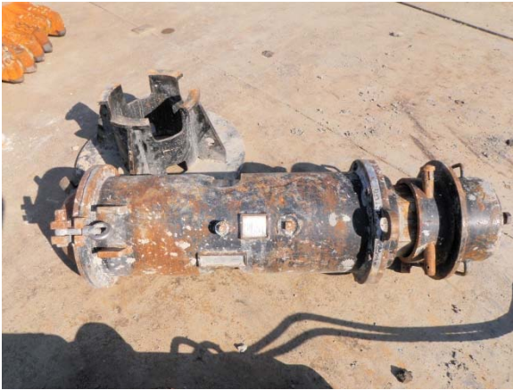
写真1 未固結試料採取に用いた採取器
