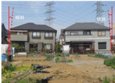
写真-1 液状化により傾斜した住宅<sup>1)</sup>
