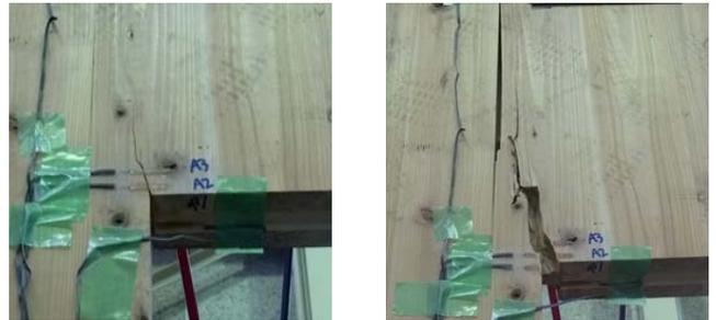
写真 1 代表的な破壊形状 (C: 掃出開口)
