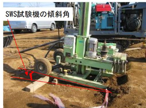
写真 1 SWS 試験機の設置状況 (傾斜角有りの場合)
