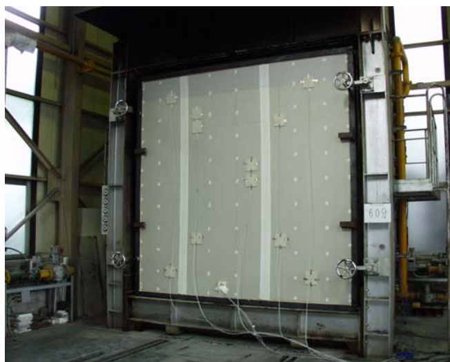
写真1：加熱60分時の非加熱面の状況
