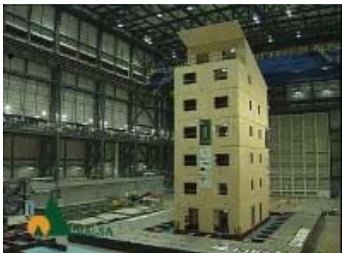
写真1 試験体震動台設置状況
