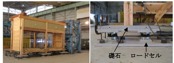
写真 1 試験体全景(南面) 写真 2 柱脚部(柱脚固定なし)
