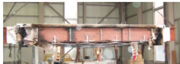
写真3 強化石膏ボードが脱落した状況
