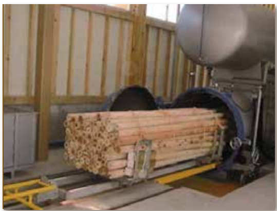
木杭は、木材防腐防蟻剤（タナリスCY）の加圧注入により長期に防腐防蟻効果が維持する。
