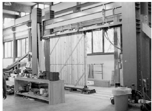
写真3 パネルの面内せん断試験装置
