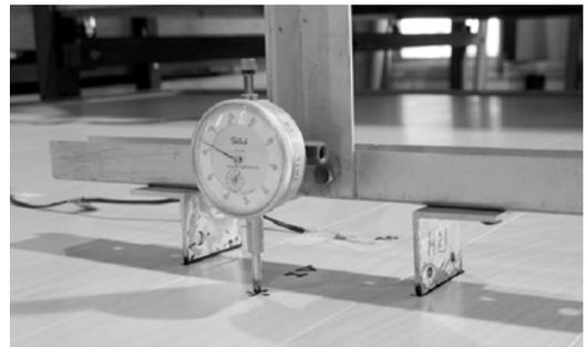
写真3 反りの測定(矢高計による)
