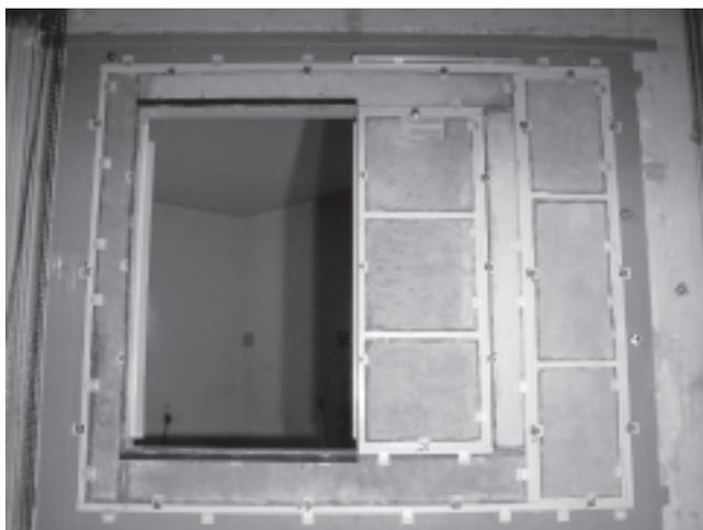
写真3 ドア用の試験開口部に調整を行った状態
