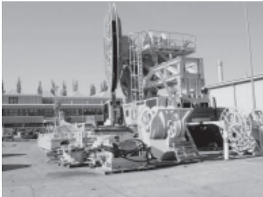
写真5 掘削機械クレーン巻き上げ部分
