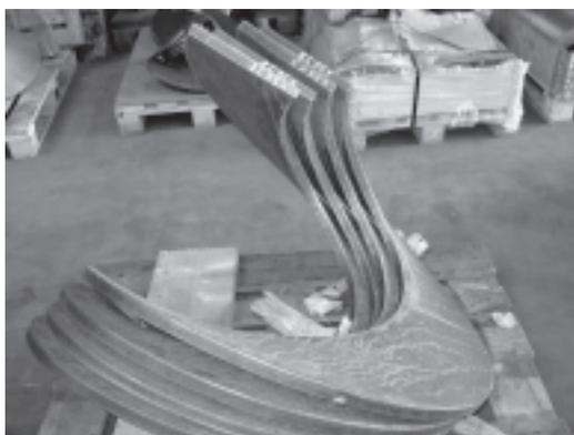
写真6 オーガ羽根：軸部への溶接が行われる(上図は仮止め状況)
