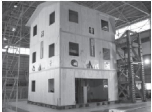
写真4 3階建振動実験 (1軸加振)
