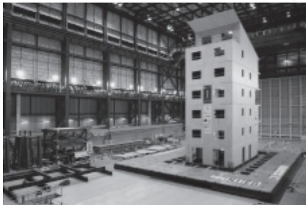
写真1 クロスラミナパネルを用いた7階建木造建築(E-ディフェンス震動台)
