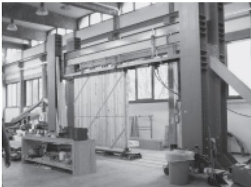
写真2 壁体静的加力実験風景 (CNR-IVALSA)
