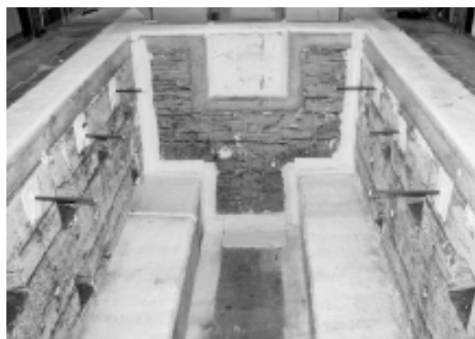
写真3 多目的水平加熱炉の炉内(2.0m x 4.0m)
