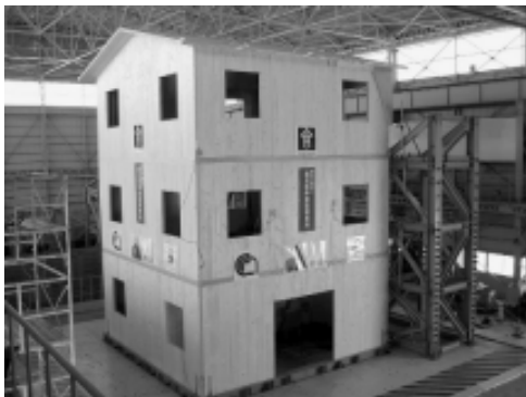
写真7 振動実験状況(Phase B)
