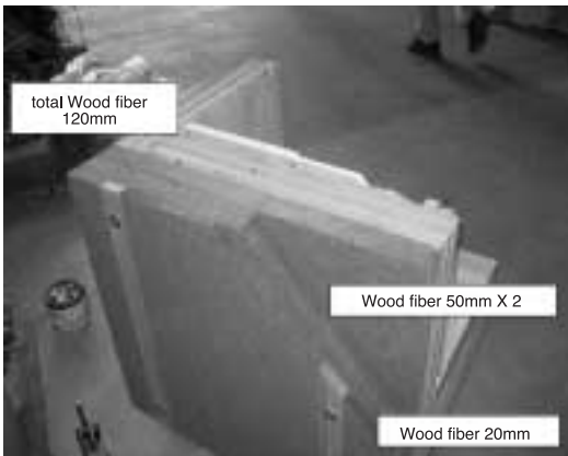
写真8 火災実験 内外装仕上げ
