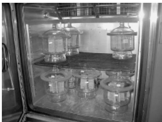
写真2 JIS A 1460 デシケータ試験状況
