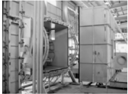
写真2 小型 天窗・屋根材用 動風圧試験装置
