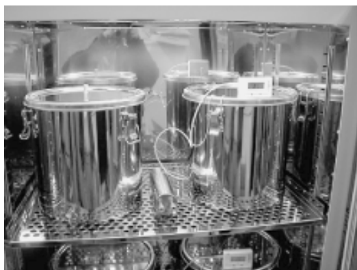
写真1 JIS A 1901 チャンパー法試験状況
