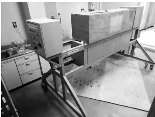
写真1 繰り返し荷重試験機全体
