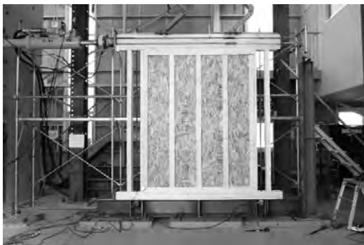
写真 2 試験状況 (ダブル仕様)
