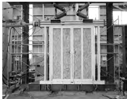
写真5 MPW耐力壁 面内せん断試験状況 (クワドラブル仕様)
