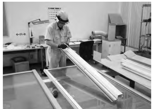
アイカメラを用いた試験体の検品状況
