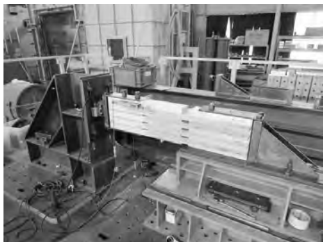
写真4 くぎ接合部二面せん断試験
