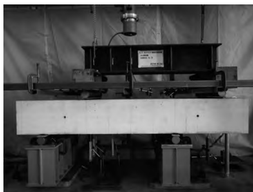
せん断試験の様子(大野式せん断加力)
