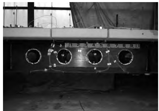
写真1 S造梁試験体の一例(母材)
