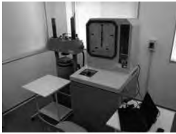
地盤改良体の 一軸圧縮強度試験 (50kN一軸圧縮試験機)
