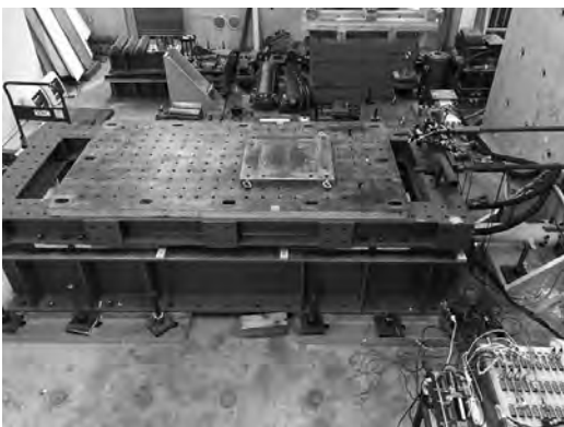
写真 2.1 簡易一軸振動台
