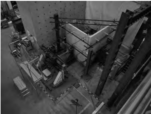
写真5 コーナー擁壁試験の一例
