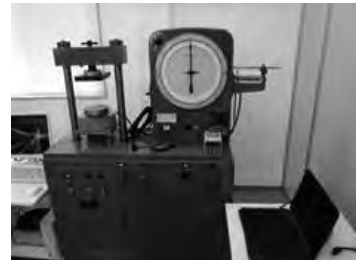
セメントミルク・モルタルの 圧縮強度試験 (200kN圧縮試験機)
