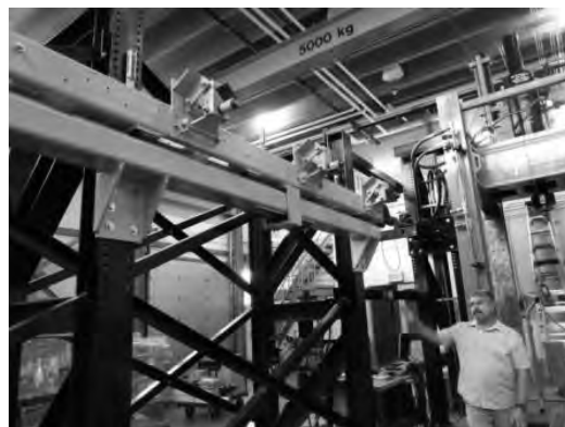
写真6 Laval CRMR Labでの壁構面せん断試験装置
