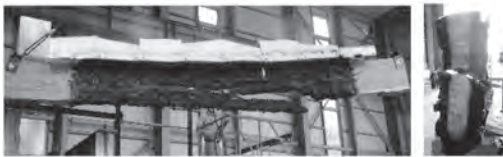
図-9(a) 実験後における破壊状況(LF-1h)
