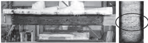
図-9(b) 実験後における破壊状況(LF-4h)
