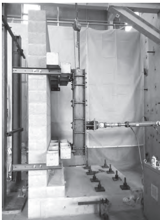
写真1 擁壁の静的載荷試験装置概要
