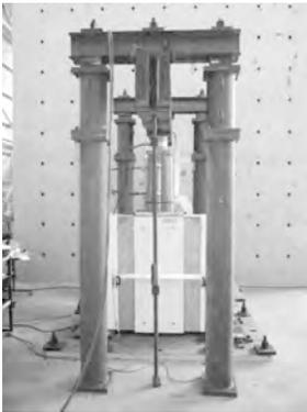
写真3.7 耐震補強用アルミブレース柱のせん断実験
