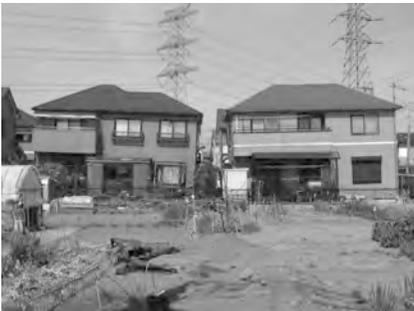
写真2 液状化により傾斜した住宅
