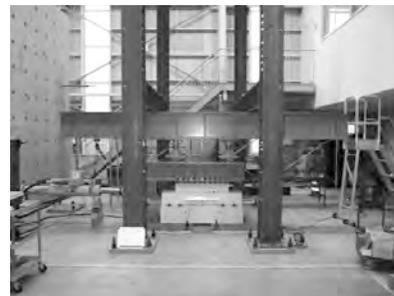
写真3.5 耐震補強用の躯体アンカー部分のせん断実験
