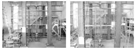
写真4.6 柱の圧縮試験状況
