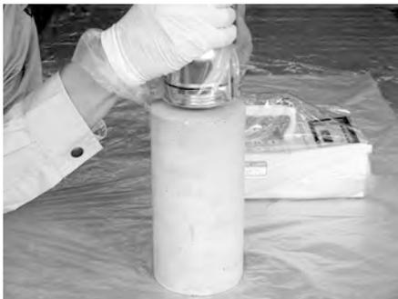
コンクリート供試体の測定
