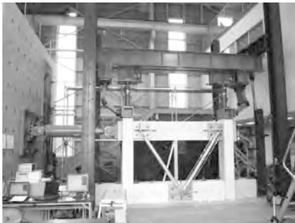
写真3.3 耐震補強用のアルミブレース構面実験
