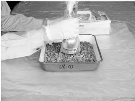
コンクリート用骨材の測定
