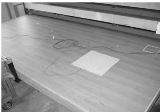
写真3 温水床暖房熱耐久試験の状況
