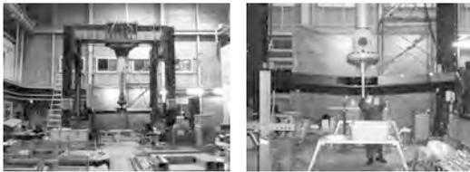
写真4.8 柱接合部の曲げ実験例
