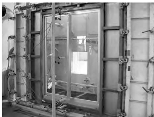
写真4 動風圧試験装置
