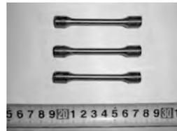
写真4.3 試験片形状の一例
