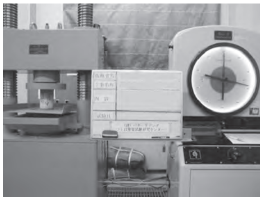
写真7 コンクリートの圧縮強度試験
