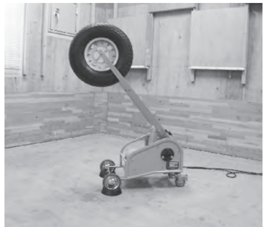
写真2 重量床衝撃音試験(バングマシン)
