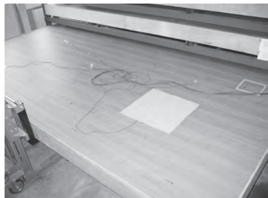
写真3 温水床暖房熱耐久試験
