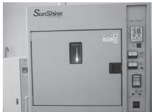
写真5 サンシャインウェザーメーターによる促進耐候性試験
