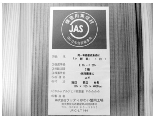
写真3 試験体構成材料の確認状況(規格表示及び樹種の目視確認)
