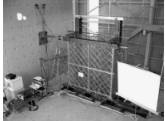
写真3 アルミニウム合金を用いたシステム建築の耐震要素試験状況
