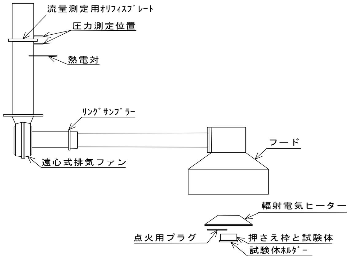
別図 1 試験装置概要 (単位 : mm)
