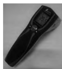
写真3 表面温度の計測に使用した放射温度計
