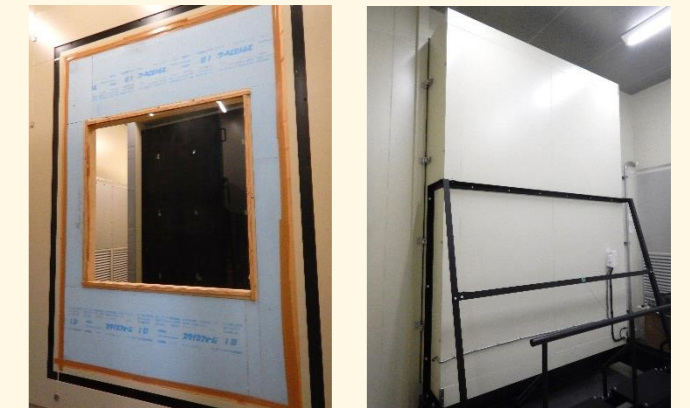
A-B室間での熱貫流率試験
