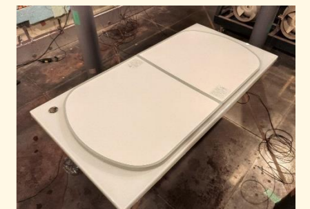
浴槽の断熱試験
