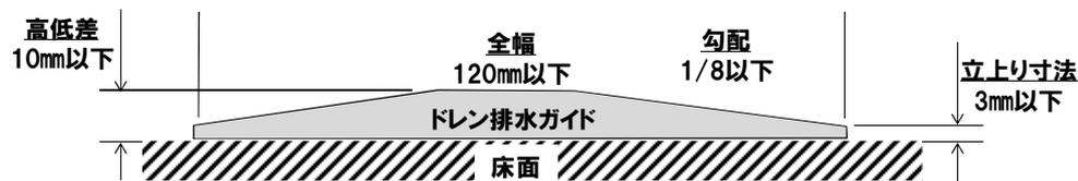
図-1 潜熱回収型ガス給湯機ドレン排水ガイドの寸法図 (参考)
