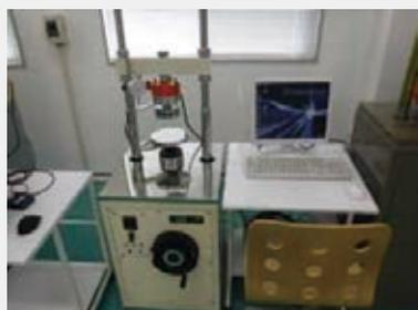
地盤改良体の一軸圧縮強度試験
