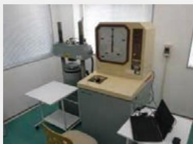
コンクリートの圧縮強度試験
