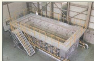
多目的水平加熱炉
